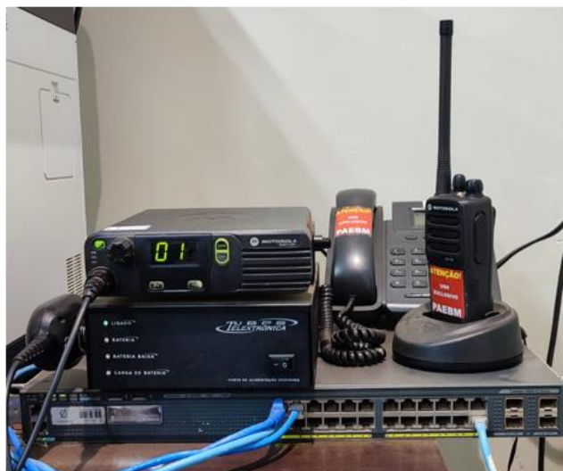
Figura 17 Rádio fixo, móvel e ramal da Sala de Crise
